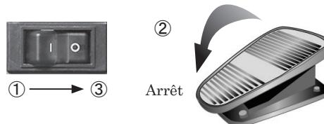
① Mettez l'interrupteur-disjoncteur d'alimentation sur la position d'arrêt (off). (Reportez-vous à l'illustration.)
